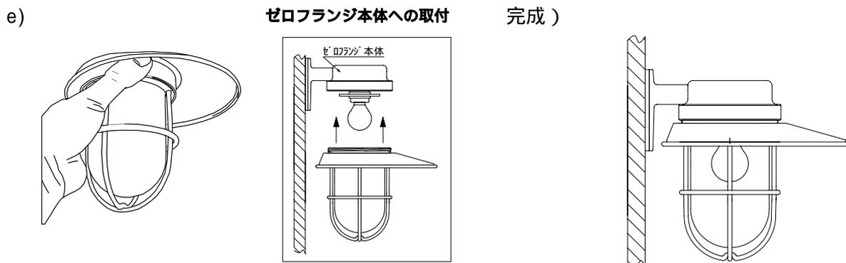
・ ゼロフランジ本体へ 180 セード の位置を調整しながらしっかりと締め付けてください。・・・図 e)
