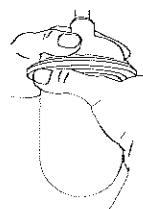
**(4) ランプを交換する。****(5) 本体を持ってグローブを回して取り付ける。**
